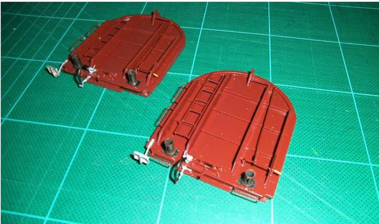
Kupplungen und Puffer werden montiert an die Stirnseiten, und die Stirnseiten werden auf das Gehäuse geklebt.
