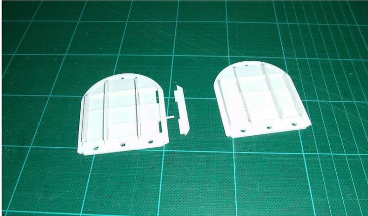
An die Innenseite werden die Verstärkungen an die Pufferbohle angeklebt, die auch den Wagenboden stützen.
