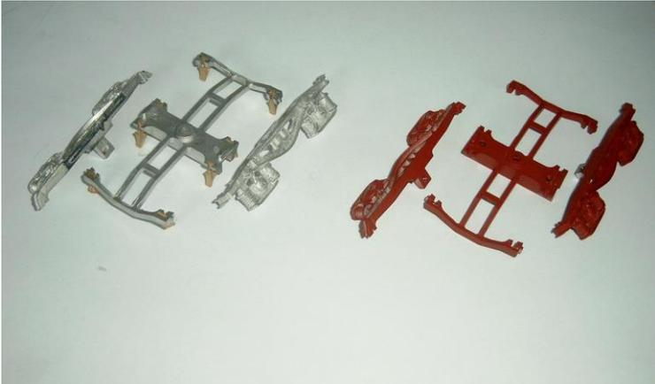
Weiter bekommen die Drehgestelle einem rot braunen (Ral 8012) oder Graphitschwarzen (Ral 9011) Lackanstrich, und werden die Rads ätze mit Gleitlager eingeschoben.
